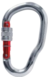
K5420PE HMS JUMBO screw gate polished / red elox ◀▶ 22 kN ◀ 9 kN ◀ 8 kN gate opening (d) 25 mm ■ 94 g CE 0639 ■ EN 12275
