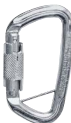
K4290PP D BAR CARABINER TWIST LOCK with twist lock and captive bar, polished ◀▶ 30 kN ◀ 9 kN ◀ 11 kN gate opening (d) 19 mm ■ 81 g CE 0639 ■ EN 362 ■ EN 12275
