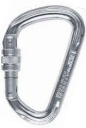
K5070PP D BIG CONNECTOR SCREW GATE polished ◀▶ 30 kN ◀ 8 kN ◀ 9 kN gate opening (d) 26 mm ■ 88 g CE 0639 ■ EN 362 ■ EN 12275
