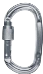
K4630PP CARABINER LOCK OVAL screw gate, polished ◀▶ 24 kN ◀ 8 kN ◀ 7 kN gate opening (d) 20 mm ■ 74 g CE 0639 ■ EN 12275 ■ EN 362
